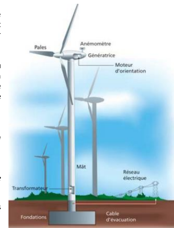
Figure 8 : Représentation schématique d'une éolienne (Source : EDF)
